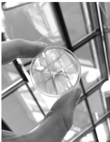
Bild 1: Replizierte Kunststofflinse mit Fresnelstruktur
