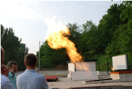
Zündung der offenen Flamme in einem Graben und in einer gasgefüllten Kammer
