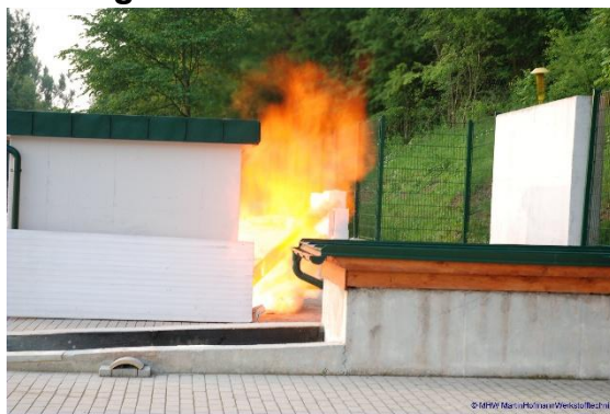
Zündung der offenen Flamme in einem Graben und in einer gasgefüllten Kammer
