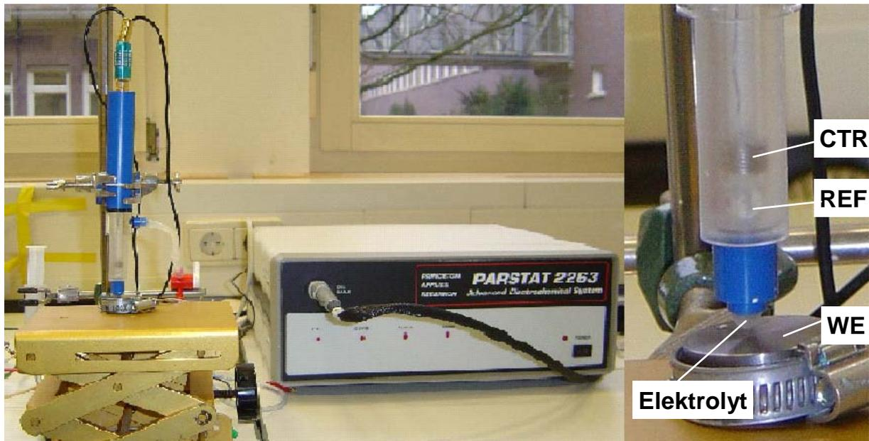
Bild 3. Elektrochemische Minizelle mit drei Elektroden: WE - Arbeitselektrode, CTR – Gegenelektrode und REF - Bezugselektrode.
